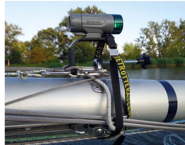
Bild 1: Improvisierte Erleuchtung: Ein handliches Zweifarbenlicht dient als Positionslampe am gelegten Mast.
