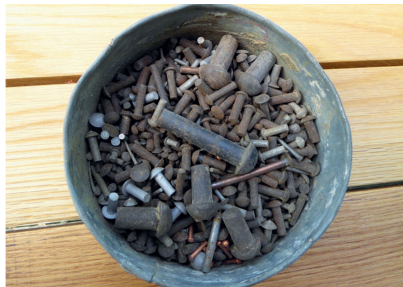
Rohe Niete (hier noch mit dem „Setzkopf“ ohne den gestauchten „Schießkopf“) verschiedener Größe aus dem Fundus des Großvaters – ein ehemaliger Schiffszimmermann.
