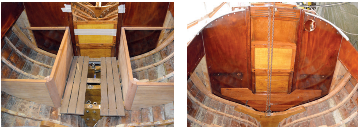
Solide Arbeit: Die neuen Backskisten bestehen aus Vollholzrahmen und Sperrholzplatten mit aufgeleimten Teakstabdeckelementen (links). Sämtliche neuen Spanten und schadhaften Nieten wurden an insgesamt fünf langen Tagen neu vernietet (rechts). Foto: Vincent Regenhardt
