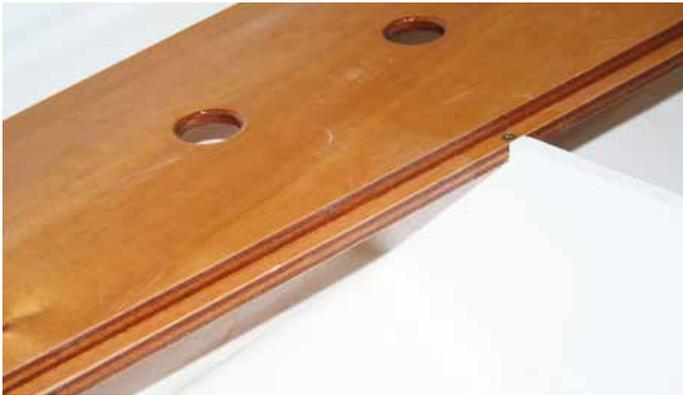
Das Sperrholz besteht aus mehreren Schichten, dadurch kann es Bewegungen besser abfangen.
