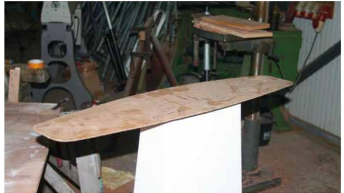
Schablone des Traveller Balken und die Positivform des Sockels.
