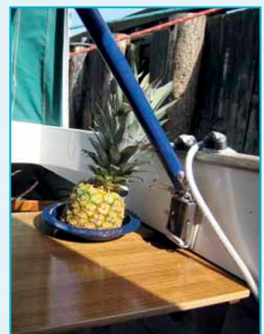
(von oben) Höhere Anbringung der Persenningknöpfe, Cockpitzelt als Verlängerung der Spritzkappe und des Segelkleids, passgenauer Schutz des Großbaums und einseitige Abstützung der Baumstütze als Ersatz für den Reitbalken im Hafen.
