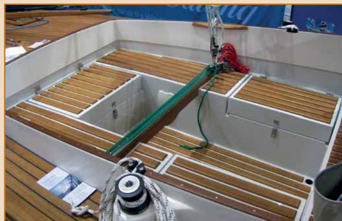
Details des aktuellen Folkeboots und das selbstlenzende Cockpit (Alle Photos Tilman Urbach)
