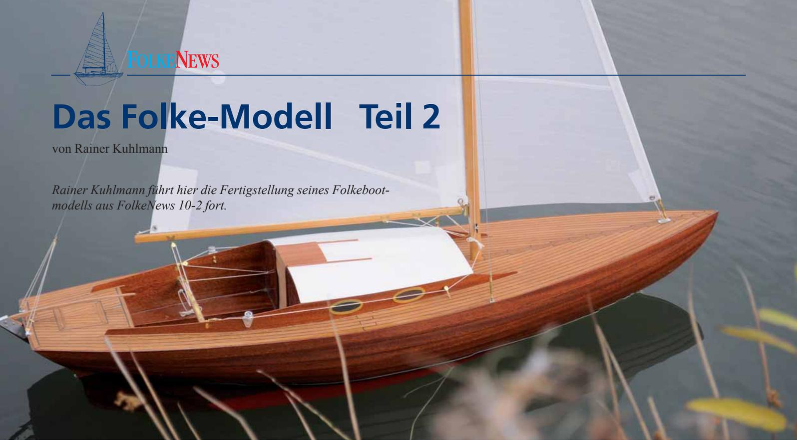
Wie im ersten Teil beschrieben, sind Rumpf, Deck und Kajüte im Rohbau bereits fertig. Das Ruder wird über zwei Seilzüge mit Umlenkrollen von der Kajüte aus angelenkt. Da die Segel wie beim Original weit aufgefiert werden können sollen und auch die Schotführung weitgehendst vorbildgetreu verlaufen soll, stellte die Betätigung der Schoten allerdings noch eine kleine Herausforderung dar.
