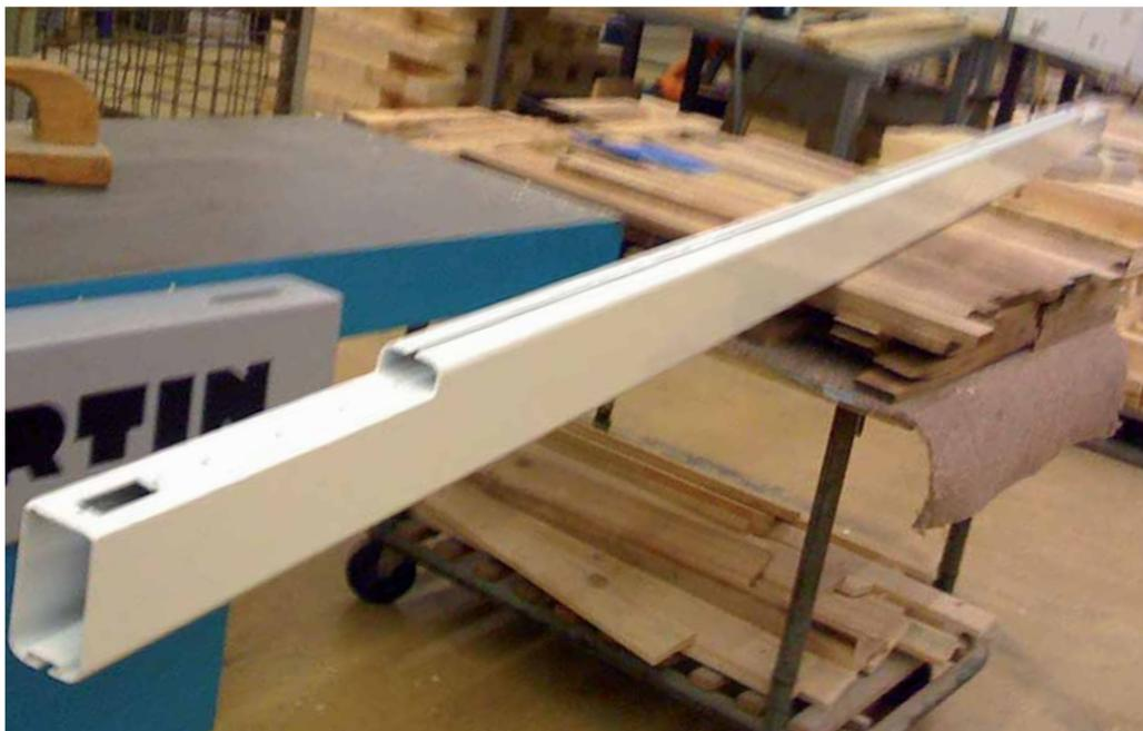
Doch bei stärkeren Winden treten insbesondere bei den Halsen starke Kräfte auf. Diese wirken vom Großbaum zum Mast hin. Und der im allgemeinen verwendete Lümmelbeschlag kann sich dabei verformen (Siehe Bild 1+2). Beim Holz-Großbaum werden diese Kräfte durch das massive Material absorbiert. Das Profil vom Alubaum ist jedoch hohl und der Lümmelbeschlag kann dann in das Bauminnere gedrückt werden.
