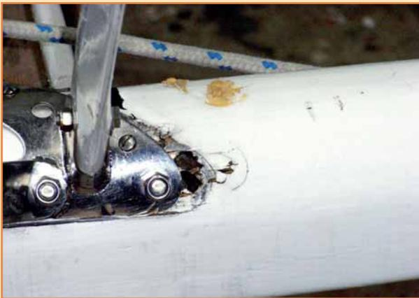
Bild 1: Hauptbeschlag abgesackt!
