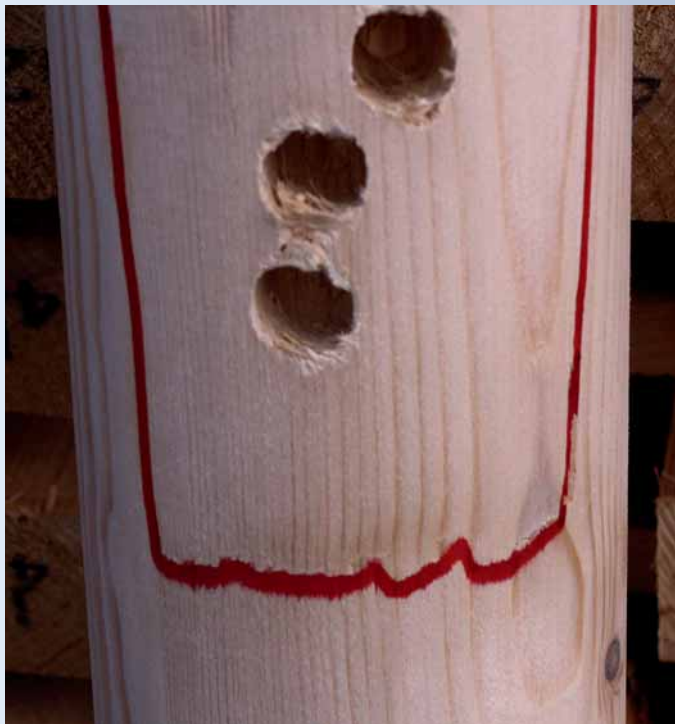
Holz ist ein Naturstoff, und noch der schönste Mast kann gewachsene Schwachstellen enthalten
