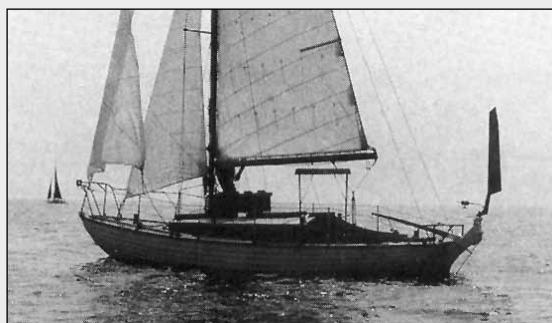
Van Hassler installierte auf EIRA für die Hochseeregatta zwei Vorstagen, Seereling, permanente Baumstütze, Selbststeuer und viele Verstärkungen im Rigg
